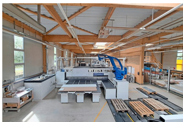
Die neue vollautomatische Zuschnittmaschine schneidet sämtliche Platten auf die gewünschte Grösse. Foto: PD
